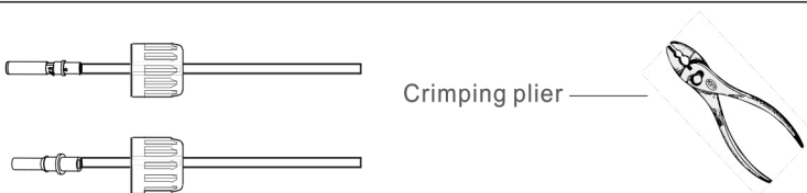
Figura 3.4 Prenda o pino de contato ao fio
